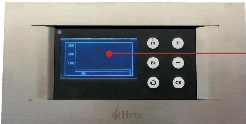
*Informazioni sulle temperature per l'ultimo inserimento e della combustione, e per l'inserimento e la combustione attuali.*
