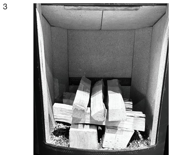
Aprire l'aria di combustione completamente e mantenere l'eventuale sportello socchiuso (non è necessario mantenerlo socchiuso, ma può accelerare l'accensione del combustibile). Il legno si accenderà molto velocemente (circa in 1-3 minuti). Se l'accensione è avvenuta a sportello aperto, questo va chiuso poco dopo e, quando il fuoco ha attecchito bene sul legno, l'aria di combustione va regolata al livello desiderato.
