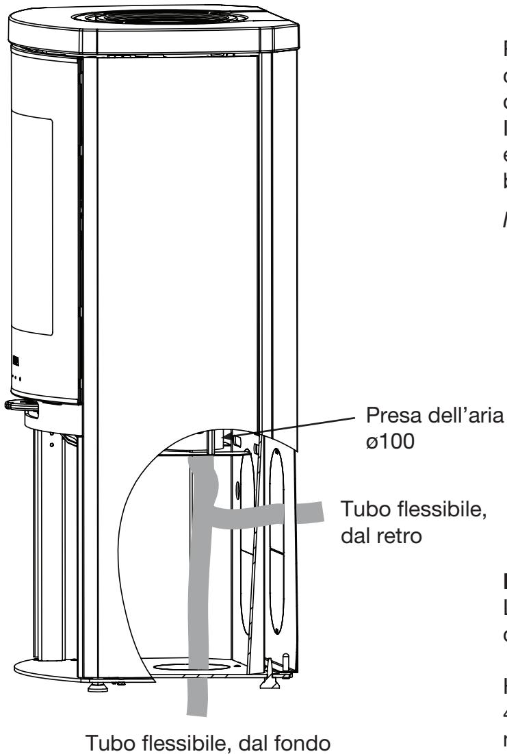
Per il montaggio di una presa d'aria esterna, collegare un tubo flessibile dalla regolazione dell'aria allo scarico dell'aria dietro la stufa. Inoltre, è possibile montare la presa d'aria esterna attraverso il fondo con un tubo flessibile.
