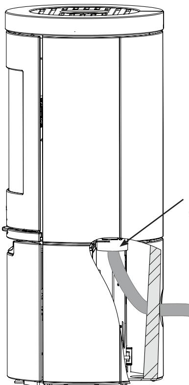
Per il montaggio di una presa d'aria esterna, collegare un tubo flessibile dalla regolazione dell'aria allo scarico dell'aria dietro la stufa.
