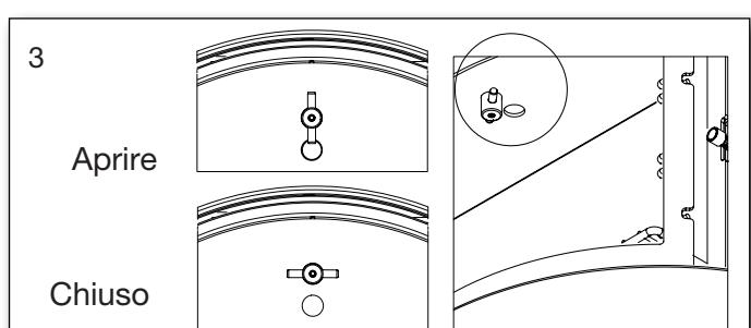
Aprire l'aria di combustione completamente e mantenere l'eventuale sportello socchiuso (non è necessario mantenerlo socchiuso, ma può accelerare l'accensione del combustibile).
